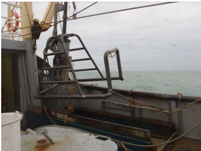
Figuur 4: De gebruikte boxcorer en opvangslede aan boord van de BRA7
